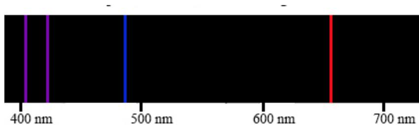
Figura 21. Espectro de emisión del hidrógeno al ser calentado
