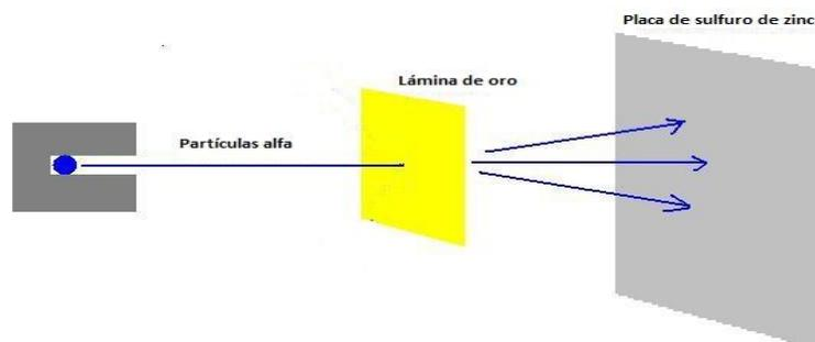
**Fig. 12.** El fenómeno de scattering de las partículas alfa en los primeros experimentos de Rutherford. Las partículas son emitidas por un material radiactivo e impactan en una finísima lámina de oro (de  $4 \times 10^{-5}$  cm). Al atravesarla, son dispersadas en pequeños ángulos.
