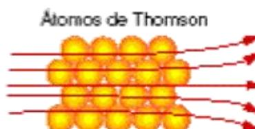
**Fig. 14.** El fenómeno del scattering en pequeños ángulos no implicaba ninguna amenaza para el modelo atómico de Thomson: las desviaciones podían explicarse por el flujo de carga positiva en el interior del átomo que alteraban el curso de las partículas alfa.
