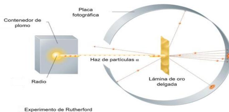
**Fig. 13.** Experimento realizado por Geiger y Marsden: rodeando la lámina de oro de una placa de sulfuro de zinc. Se observaba que las partículas alfa no sólo sufrían desviaciones pequeñas, sino también que unas pocas incluso rebotaban.
