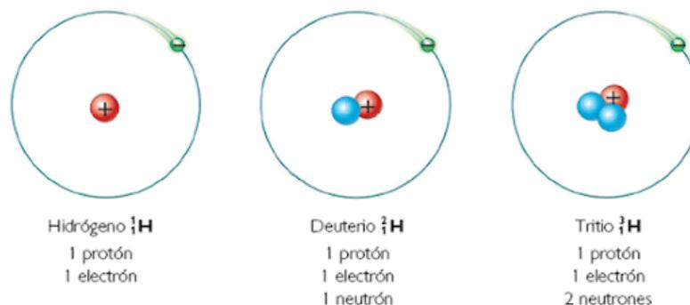
Fig.12. Isótopos naturales del hidrógeno.
