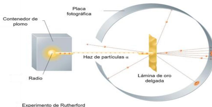
**Fig. 17.** Experimento realizado por Geiger y Marsden: rodeando la lámina de oro de una placa de sulfuro de zinc. Se observaba que las partículas alfa no sólo sufrían desviaciones pequeñas, sino también que unas pocas incluso rebotaban.
