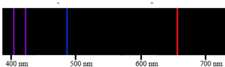
**Figura 23.** Espectro de emisión del hidrógeno al ser calentado
