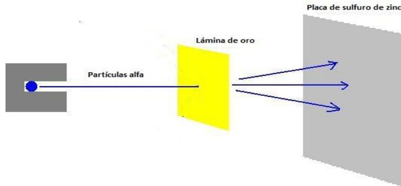
**Fig. 16.** El fenómeno de scattering de las partículas alfa en los primeros experimentos de Rutherford. Las partículas son emitidas por un material radiactivo e impactan en una finísima lámina de oro (de  $4 \times 10^{-5}$  cm). Al atravesarla, son dispersadas en pequeños ángulos.
