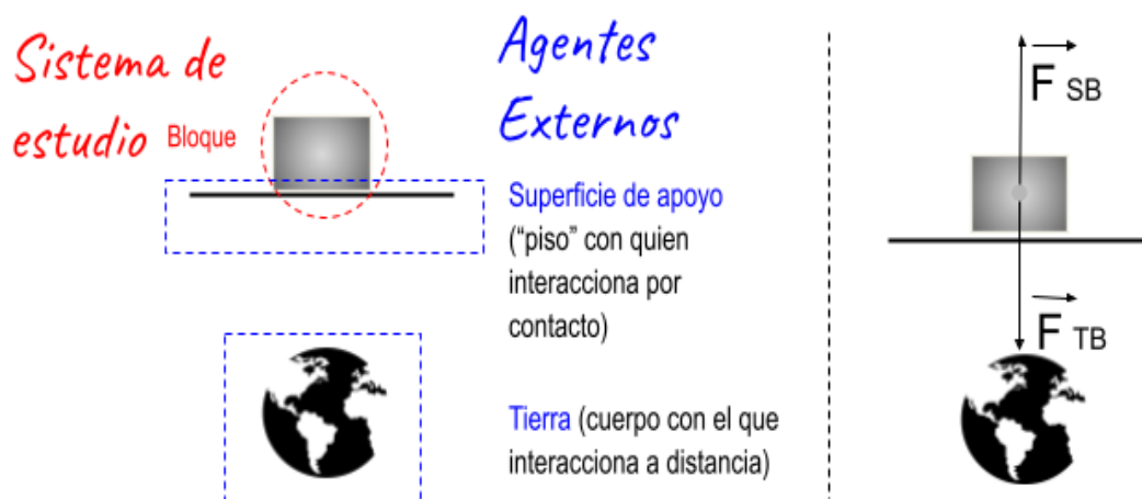
Fig. 8. Identificación de sistema de estudio y agentes externos. Fuerzas que se ejercen sobre el bloque. F_{SB} (Fuerza que la superficie ejerce sobre el bloque) y F_{TB} (fuerza que la Tierra ejerce sobre el bloque)
