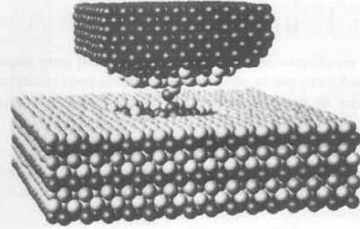
Dibujo de ordenador que muestra cómo unos cuantos átomos de oro (abajo) se adhieren a la punta fina (arriba) de una sonda de níquel que ha estado en contacto con la superficie de oro.
