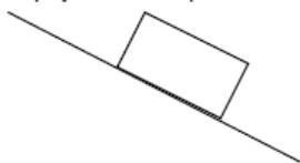
Podemos representar las fuerzas que actúan sobre el bloque, pero debemos considerar que los ejes siguen siendo: paralelo (eje x), y perpendicular (eje y) al plano
