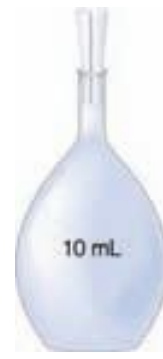
Figura 3.20 Picnómetro. El que se muestra aquí tiene una capacidad de 10 mL. Los picnómetros sirven para determinar con precisión densidades y densidades relativas de líquidos.
