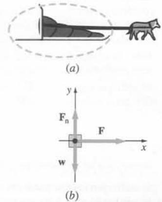
**Figura 4.8** (a) Un perro tira de un trineo. El primer paso para resolver este problema es aislar el sistema que deseamos analizar. En este caso la curva cerrada de puntos aísla el cuerpo trineo-cuerda de sus alrededores. (b) Las fuerzas que actúan sobre el trineo de (a).
