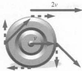
**Figura 5.17** Cuando una rueda gira sin deslizar, cada punto de la periferia posee una velocidad de magnitud  $v$  relativa al centro de la rueda, en donde  $v$  es la velocidad del centro de la rueda al suelo. La velocidad del punto sobre el neumático en contacto con el suelo es cero respecto al suelo. En esta figura las líneas de puntos representan velocidades respecto al centro de la rueda y las líneas continuas representan velocidades respecto al suelo.
