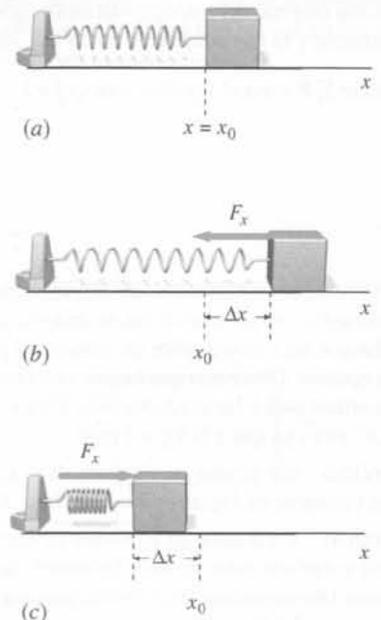
Figura 4.5 Muelle horizontal. (a) Cuando el muelle no está tenso, no ejerce ninguna fuerza sobre el bloque. (b) Cuando el muelle se estira, de modo que  $\Delta x$  es positivo, ejerce una fuerza de magnitud  $k \Delta x$  en el sentido negativo de  $x$ . (c) Cuando el muelle se comprime, de modo que  $\Delta x$  es negativo, el muelle ejerce una fuerza de magnitud  $k |\Delta x|$  en sentido positivo.
