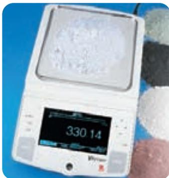
**Figura 3.11** Balanza ranataria electrónica.
