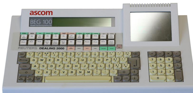
Un teclado Ascom BEG 100 de Ascom Bankensysteme AG, creado específicamente para funcionar con el sistema de información financiera Reuters Dealing 2000. El teclado en este caso es un periférico de entrada y de salida.
