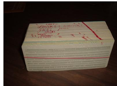
Un programa escrito en tarjetas perforadas. Las marcas en la parte superior de la pila de cartas permitía identificar el programa y visualizar sus diversas partes.
