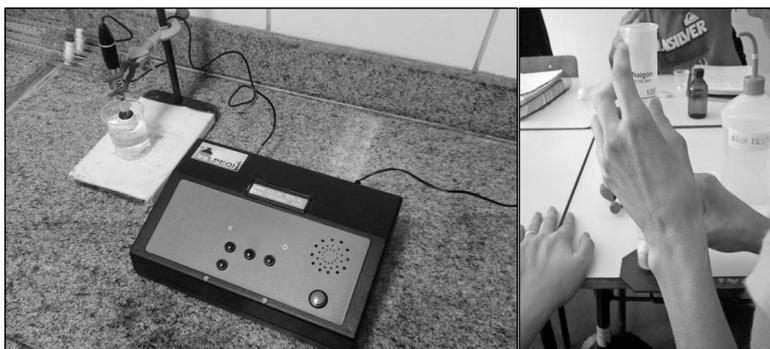
Figura 1: pHmetro vocalizado e proveta com sistema de boia.
