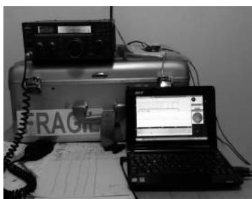
Equipamiento básico usado por UV en Marambio para activaciones en modo digital PSK-31.
